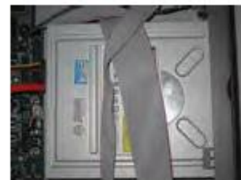
Rys. 2.3 Umieszczenie nagrywarki DVD
