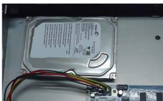
Umieść dysk twardego na dnie obudowy
