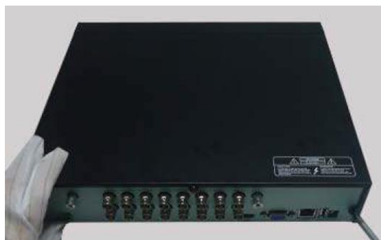
Odkręć śrubki górnej pokrywy i zdejmij ją
